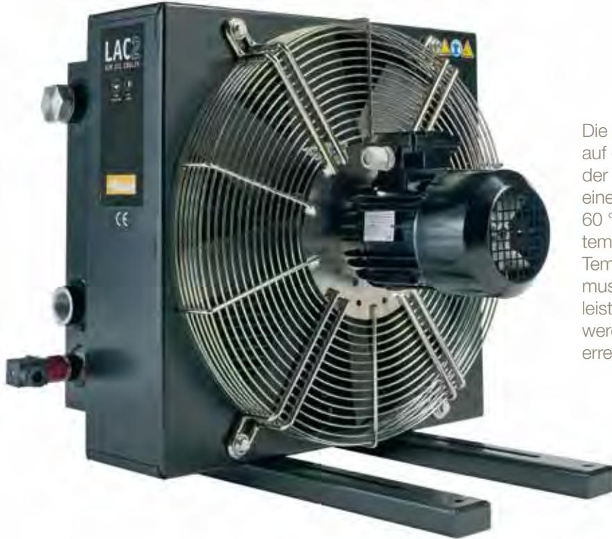
Die Kühlleistungskurven basieren auf der Öleintrittstemperatur und der Umgebungstemperatur. Bei einer Öleintrittstemperatur von 60 °C und einer Umgebungstemperatur von 20 °C beträgt die Temperaturdifferenz 40 °C. Diese muss mit der spezifischen Kühlleistung in kW/ °C multipliziert werden, um die Kühlleistung zu errechnen.
