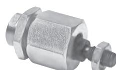
Flexo-Kupplung zur gelenkigen Montage der Kolbenstange. Die Flexo-Befestigung dient zum Ausgleich axialer Winkelfehler im Bereich von  $\pm 4^\circ$ .
