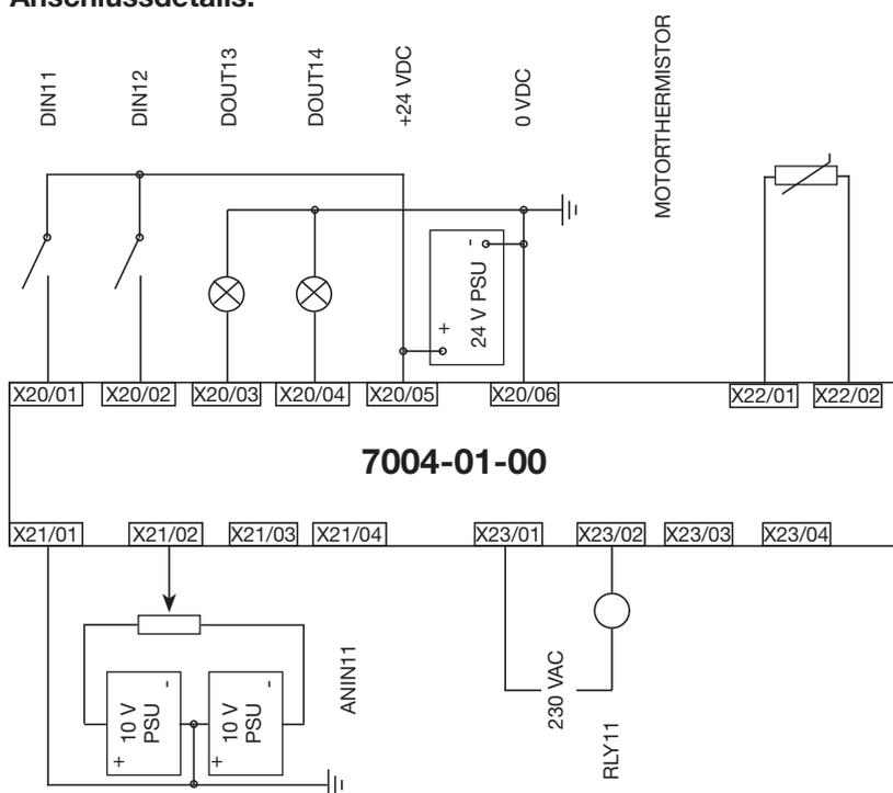
Beispielverdrahtung für GPIO Modul 7004-01-00
