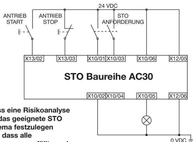
**Der Benutzer muss eine Risikoanalyse durchführen, um das geeignete STO Verdrahtungsschema festzulegen und sicherstellen, dass alle Sicherheitsanforderungen erfüllt werden.**
