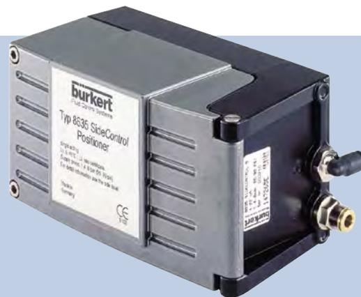
Der Positioner SideControl Typ 8635 ist ein elektropneumatischer Stellungsregler in Zweileitertechnik für pneumatisch betätigte Prozessventile mit Schub- oder Schwenkantrieb. Signalverarbeitung, Regelung und Ansteuerung des internen Stellsystems erfolgen über eine mikroprozessorgesteuerte Elektronik. Die implementierte Softwarefunktion Autotune ermöglicht eine automatische Anpassung des Stellungsreglers an das eingesetzte Regelventil.
