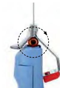
3. Führen Sie das so eingestellte Werkzeug in einer 360°-Drehung rund um den Schlauch.
