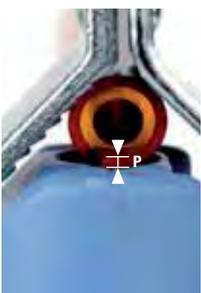
1. Legen Sie den Schlauch in den Abisolierer ein und passen Sie die Klingenhöhe an die Schlauchstärke an.
