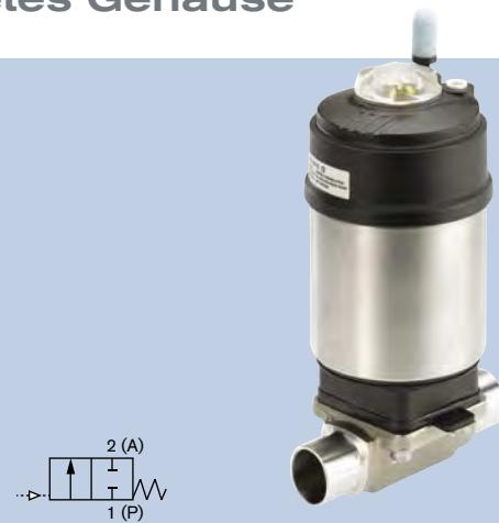
Das fremdgesteuerte Membranventil Typ 2103 besteht aus einem pneumatisch betätigten Kolbenantrieb, einer Membran und einem 2-Wege-Ventilgehäuse aus geschmiedetem Edelstahl. Der hochwertige Antrieb mit Edelstahlhülle gewährleistet den Einsatz bei hygienischen oder aggressiven Umgebungsbedingungen. Die strömungsgünstigen und totraumfreien Ventilgehäuse ermöglichen hohe Durchflusswerte und vielfältige Einsatzmöglichkeiten.
