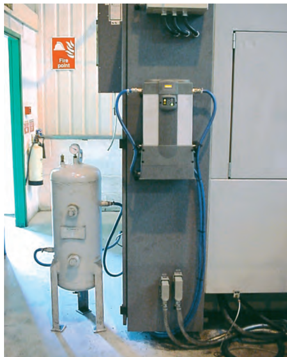
P3TJ Drucklufttrockner für die Steuerluft einer CNC-Drehmaschine
