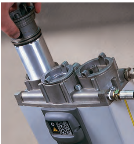
Einfacher Austausch der Trockenmittelkassette
